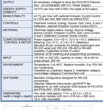
**EGPS-6210 ELECTRON GUN POWER SUPPLY SPECIFICATIONS**
